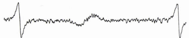
図 4 Superoxide dismutase (SOD) を混和した場合の ESR スペクトル。
