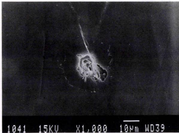
図6 ダイヤモンド状炭素膜で被覆したPMMA製眼内レンズを3.2mJのNd:YAGレーザーで照射した例。走査型電子顕微鏡写真、図5と同倍率、pit形成がみられたが、図5に比べ小さく、辺縁もより平滑である。
