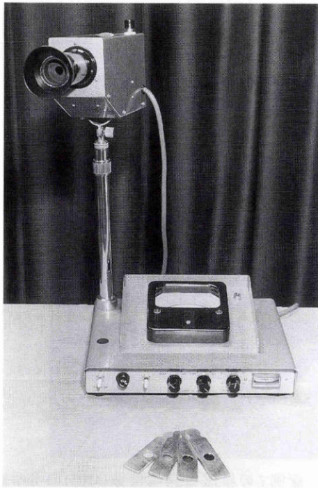
図 19 中心フリッカー値測定器の第 1 号器。
