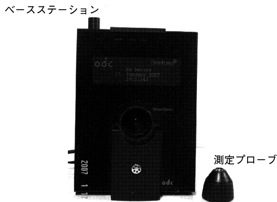
図 1 Dynamic observing tonometer (DOT) 装置. 測定プローブが主装置で, 角膜にプローブを直接触させ, 眼圧 (DOT 眼圧) と眼圧脈波幅 (OPA) を連続測定する. ベースステーションのウィンドウにも眼圧脈波幅の波形が表示される.
