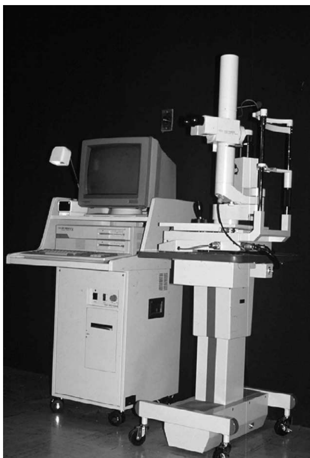
図 19 Sawa らが興和社と協力して開発したレーザーフレアセルメーター 105) .
