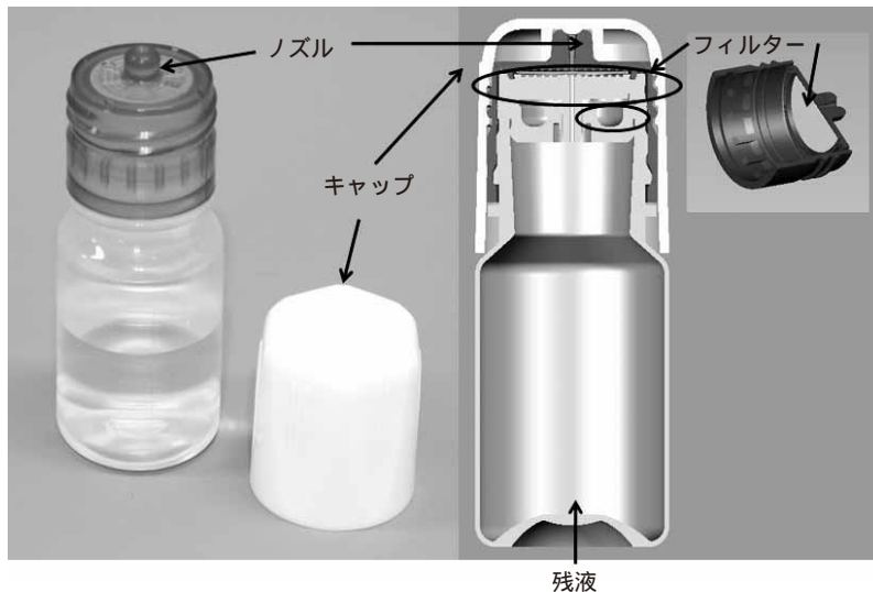
図 1 NP 容器型ニプラジロール点眼薬の微生物汚染の調査部位。
