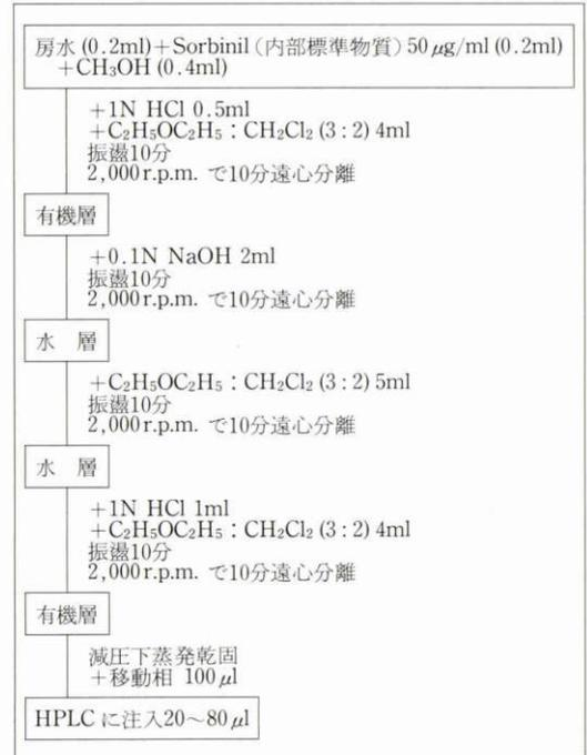
図1 試料の前処理
