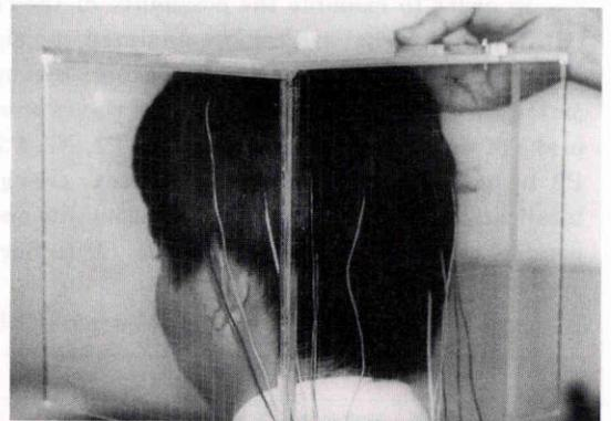
図2 測定電極の3次元的位置測定を行うための透明なプラスチック製。x軸は鼻根と後頭結節を結ぶ線とし、z軸はCzを通り、x軸に垂直、y軸はx,z軸と直交する線として計測した。
