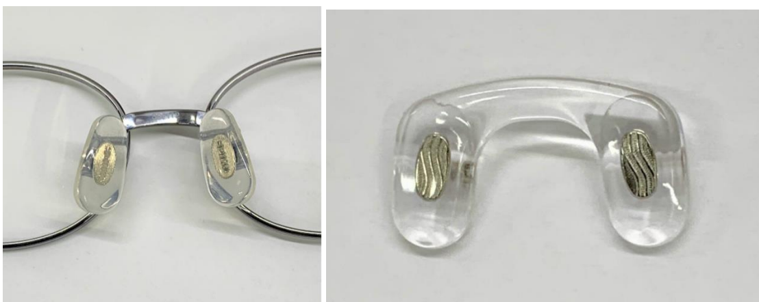
696 697 図3 金属製のメタルフレーム+ツインパッド式のノーズパッド 698 左右がブリッジで繋がっており、クリングスがつぶれた場合もブリッジ部分が鼻根部に載るため、比較的鼻眼鏡になりにくいとされている。 699
